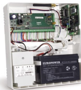
Príklad montáže zariadení do skrinky OPU-4 P
