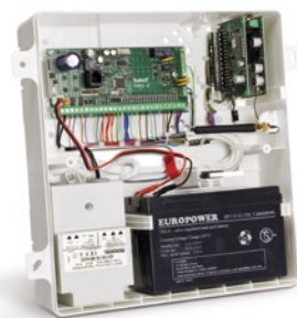
Príklad montáže zariadení do skrinky OPU-4 PW
