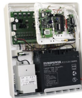
Príklad montáže zariadení do skrinky OPU-3 P
